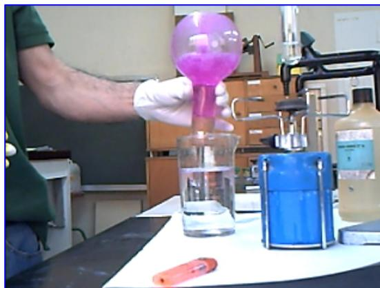
Para recoger el amoniaco colocaremos en un tubo con hidróxido amónico encima de un mechero y colocaremos el matraz invertido sobre él, recogiendo el amoniaco. Taparemos rápidamente e introduciremos el matraz invertido en agua con indicador.
