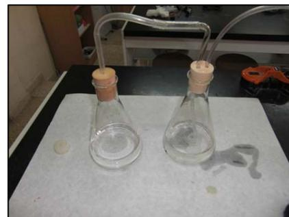
Cambio de color sucesivo por formación de ácido carbónico
